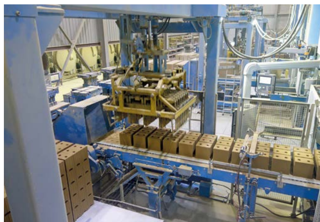
Bild 4 Nach dem Mischen werden die Rohlinge gepresst.
