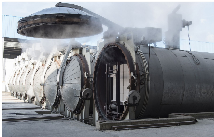
Abbildung 13: Produktion – Härtekessel; Bildquelle: © Bundesverband Kalksandsteinindustrie e.V.
