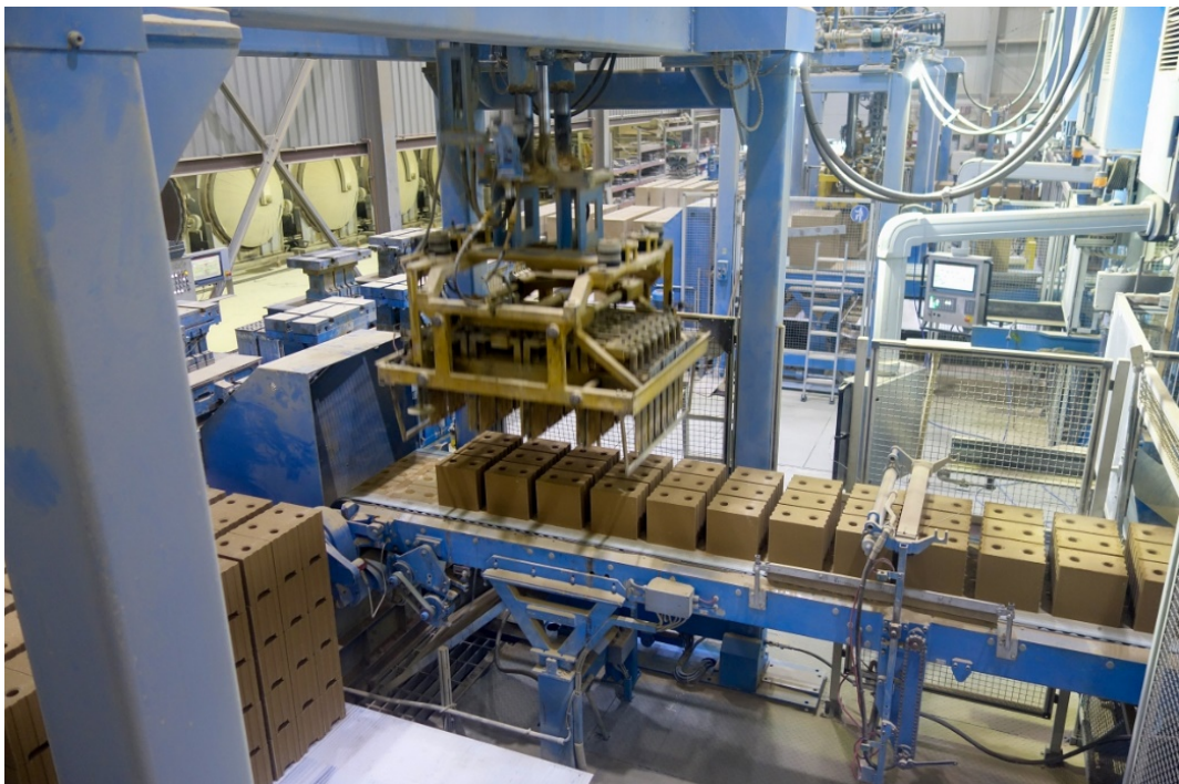
Abbildung 33: Produktionsstrasse in einem Kalksandsteinwerk; Bildquelle: © Bundesverband Kalksandsteinindustrie e.V.
