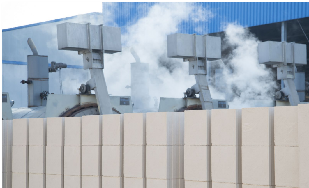
Abbildung 52: Abkühlen der Kalksandsteine; Bildquelle: © Bundesverband Kalksandsteinindustrie e.V.
