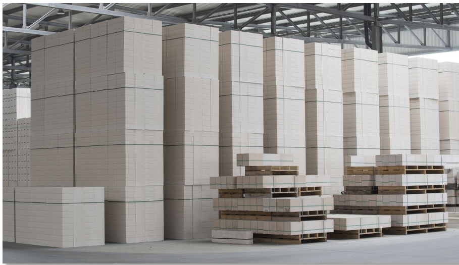
Abbildung 21: Kalksandsteinlager; Bildquelle: © Bundesverband Kalksandsteinindustrie e.V.
